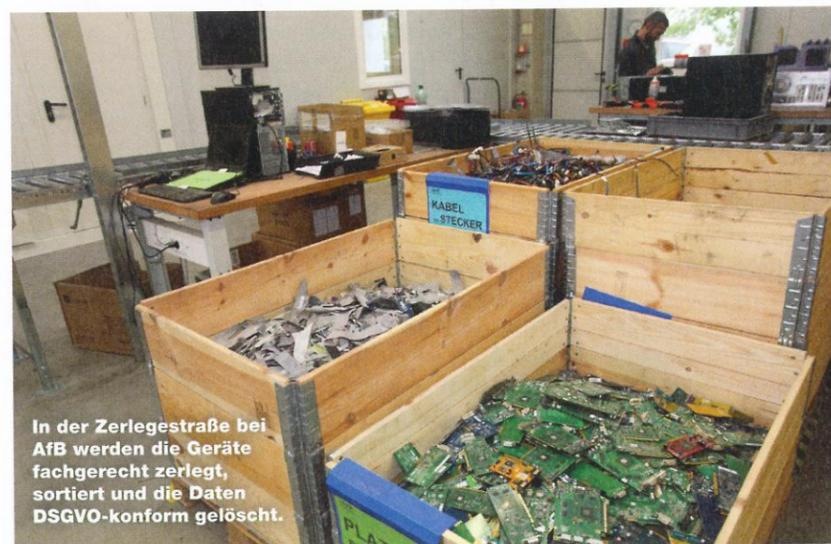
In der Zerlegestraße bei AfB werden die Geräte fachgerecht zerlegt, sortiert und die Daten DSGVO-konform gelöscht.
